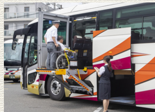
車両中央部に設置された専用リフトで、車椅子ご利用のまま安全に乗降ができます。
