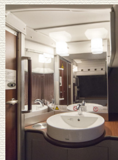
2面の大型鏡を備えた洗面台と消音機能付の清潔な洋式トイレを設置した大型洗面台付化粧室。自動水洗の洗面台は、手すりや円形シンクなど、走行中の揺れに対して安全にご利用いただける設計となっています。
